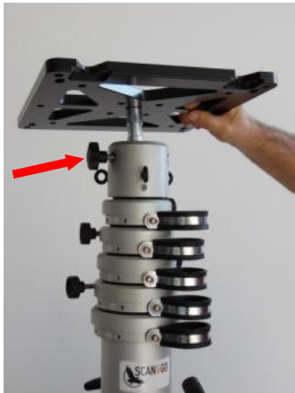
Inserire la piastra sulla testa della struttura e serrare la vite di blocco
